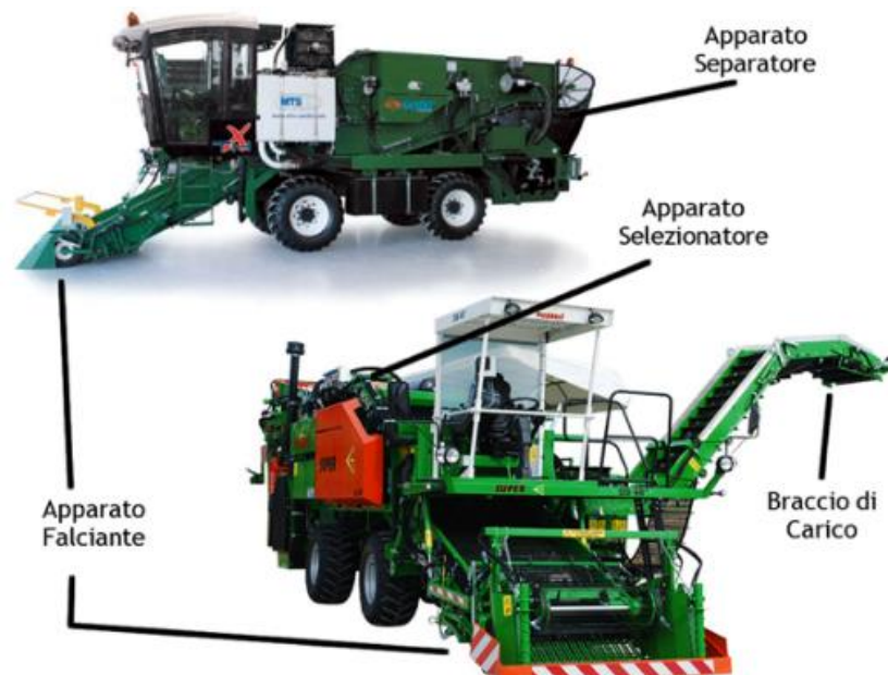
Figura 10. Raccogliatrice meccanica semovente (Monarca, 2020)
