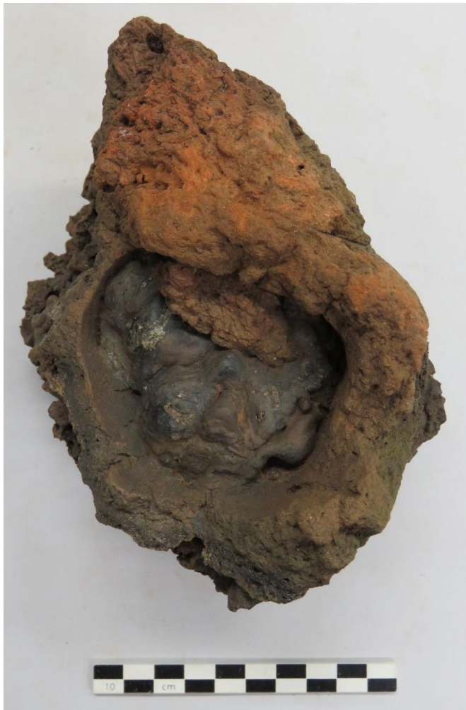
Figura 7: Sezione di tuyere, ugello di raccordo tra mantice e forno; risulta occluso da scoria fluida.
