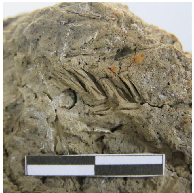
Figura 6: Campione di argilla degrassata con paglia: in particolare, si noti in negativo sulla superficie della sezione l'impressione di una spiga.
